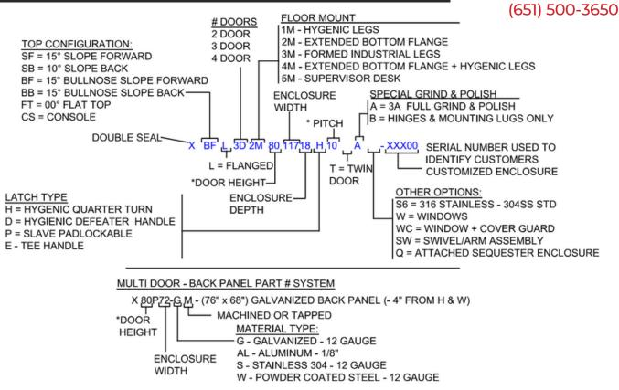
NOTE: \* BACK PANEL PART NUMBER IS TYPICALLY BASED UPON ENCLOSURE SIZE
