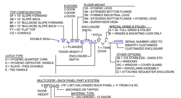
NOTE: \* BACK PANEL PART NUMBER IS TYPICALLY BASED UPON ENCLOSURE SIZE
