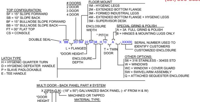
NOTE: \* BACK PANEL PART NUMBER IS TYPICALLY BASED UPON ENCLOSURE SIZE
