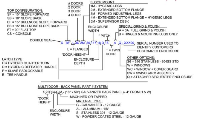
NOTE: \* BACK PANEL PART NUMBER IS TYPICALLY BASED UPON ENCLOSURE SIZE
