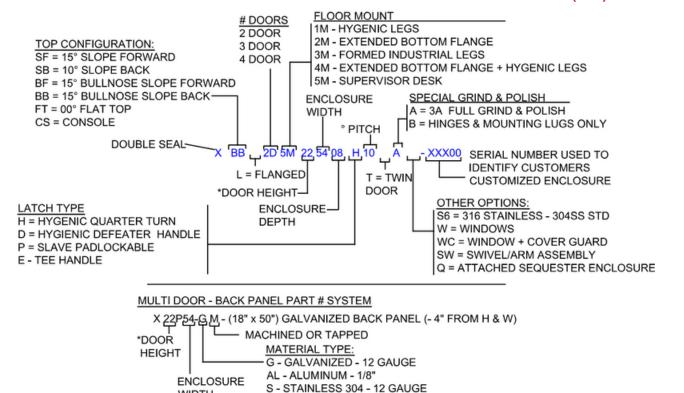
NOTE: \* BACK PANEL PART NUMBER IS TYPICALLY BASED UPON ENCLOSURE SIZE
